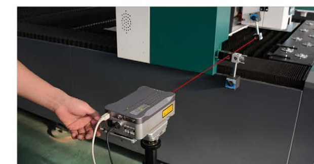
激光干涉仪保障整机运行精度
