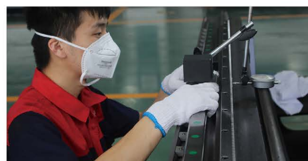
齿条平行精度调试组装
