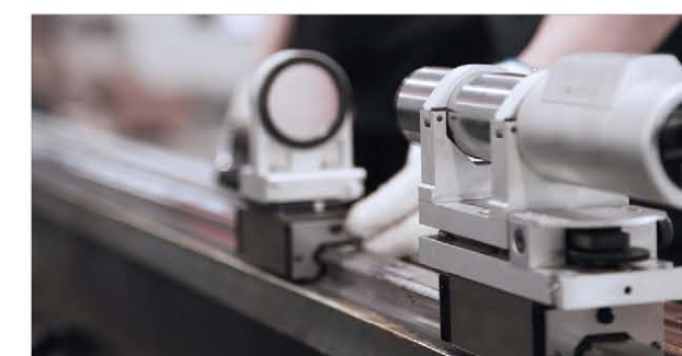
激光准直仪检测引导线
